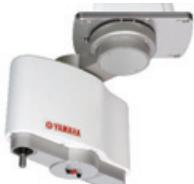
全方位型水平多关节机器人YK-TW
