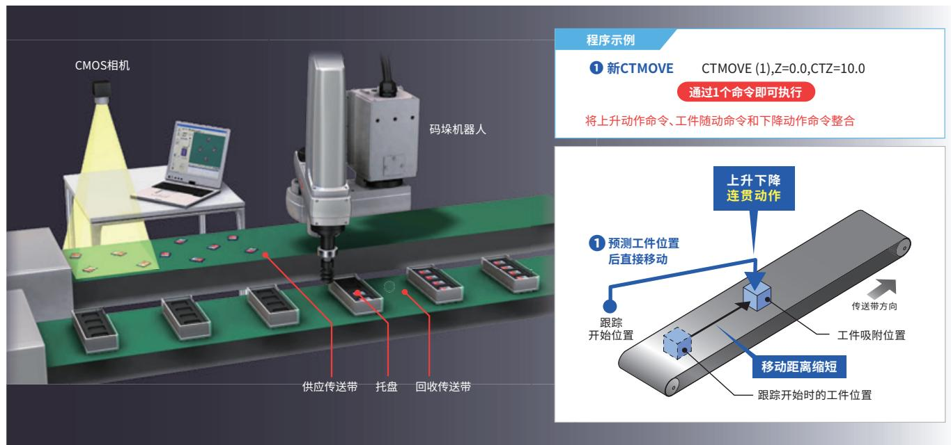
动作条件: YK500XG/搬运重量1kg(工具·工件合计)/水平移动250mm/垂直移动1mm/传送带速度100mm/sec
