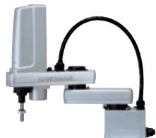
水平多关节机器人YK-XG/XE
