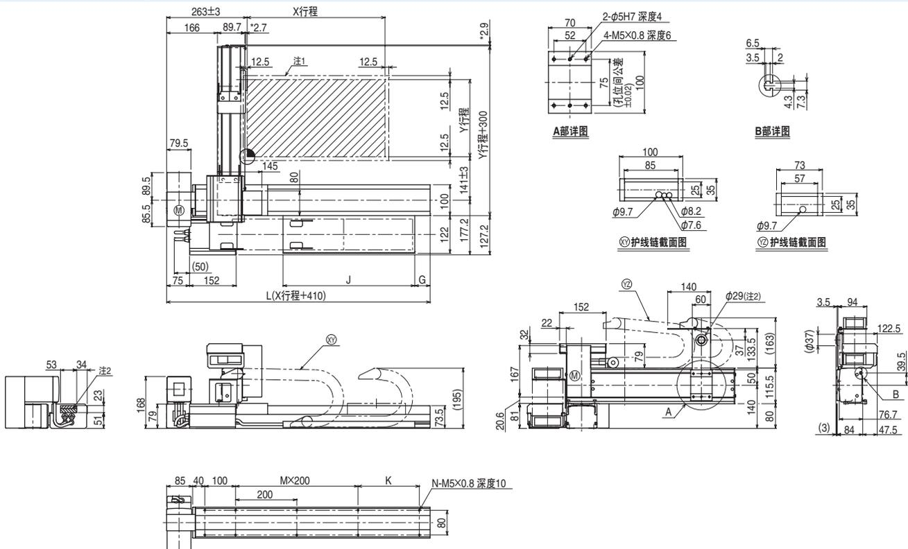
注1. 原点复位时的移动范围以及被限位器限停的位置。 注2. 斜线部分位置表示用户用的电缆出口。 注3. 图中带“\*”的尺寸为螺丝高度。
